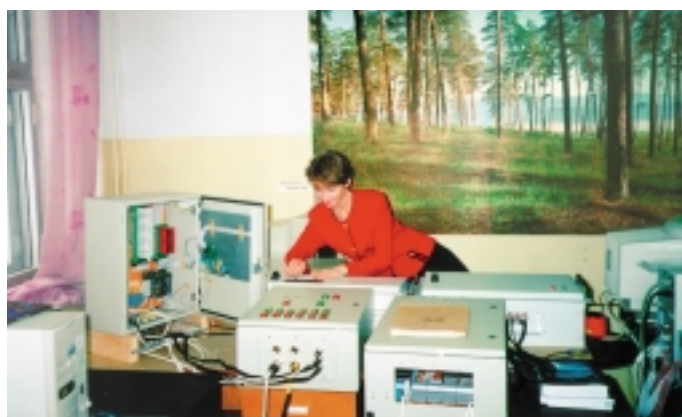
Рабочий момент отладки ТС и ПО системы ЛСУ КНС
