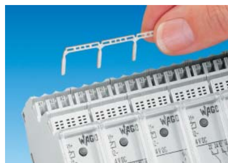
Объединение с помощью вставных перемычек
