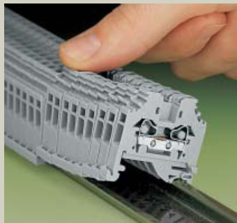
Установка на DIN-рельс. Клеммы с заземлением автоматически контактируют с рельсом
