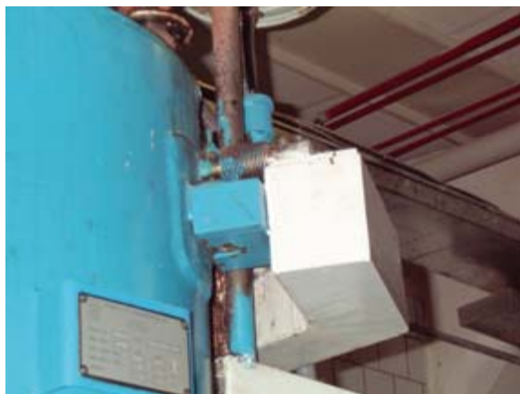
Рис. 9. Расположение тензодатчика весовой станции
