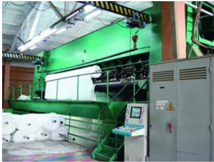
Рис. 1. Общий вид иглопробивной машины
