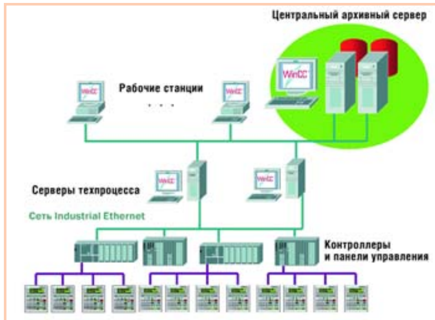
Рис. 5. Структурная схема АСУ МСТО ВКМ депо Свердловск-Сортировочный
