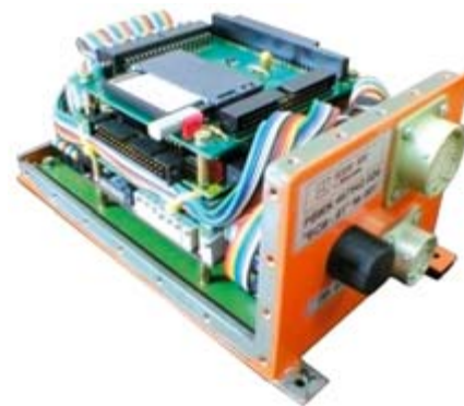
Рис. 4. Внешний вид конструкции устройства со снятой крышкой
