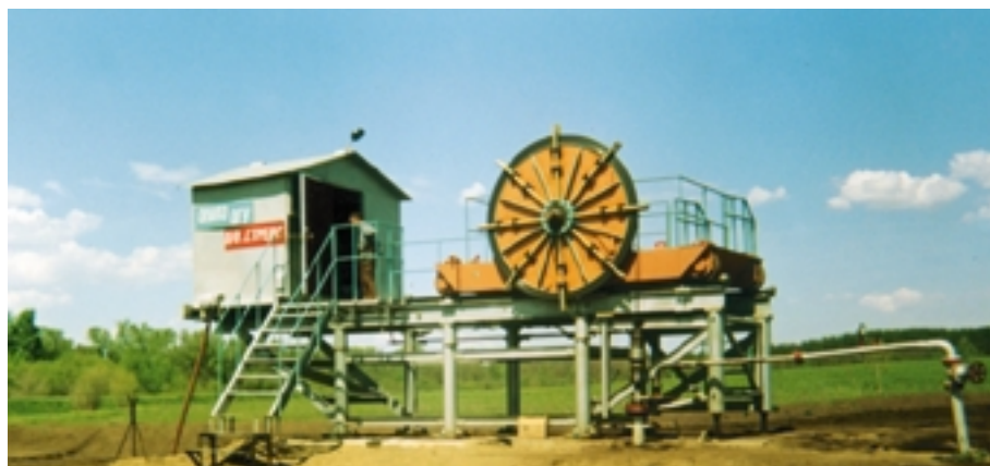
Рис. 2. Общий вид длинноходовой насосной установки
