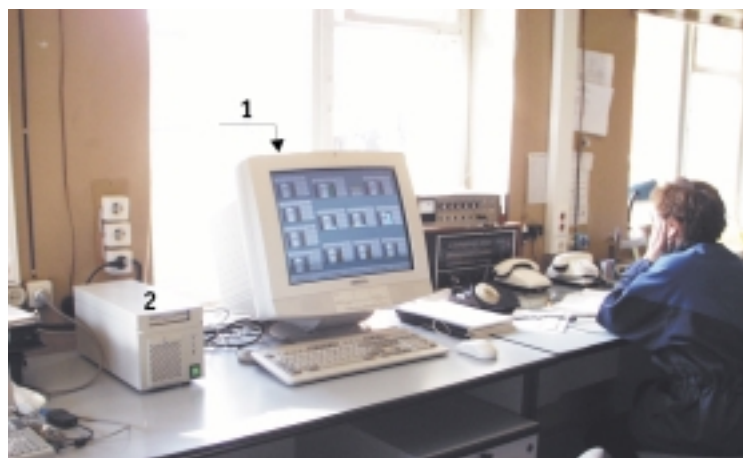
Рис. 8. Операторская станция системы измерения уровня и температуры (1 — монитор 21" Nokia 445, 2 — системный блок IPC 6806 с процессором PCA6154 фирмы Advantech)
