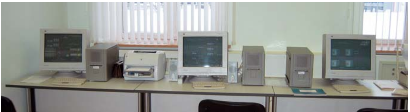
Рис. 3. Операторские станции (WS1 и WS2) и компьютер БКНС (WS3) в настольном исполнении на базе шасси IPC-6908
