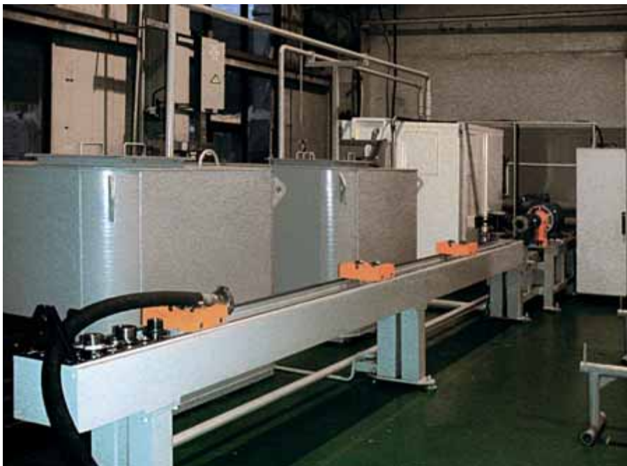
Рис. 1. Общий вид стенда тестирования погружного ЭЦН
