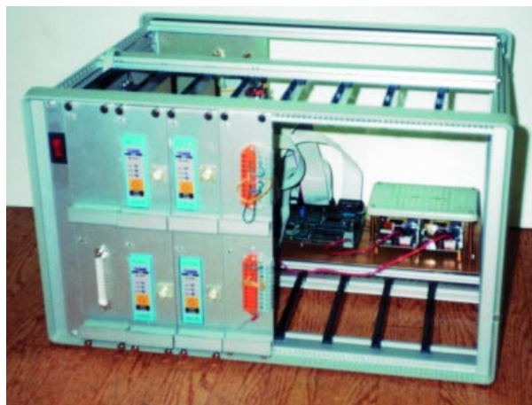
Рис. 5. Контроллер № 1 в процессе сборки; корпус Comras, слева направо: планка с выключателем питания, модуль с мультиплексором AIMUX-32, 2 модуля с тензометрическими усилителями ADAM-3016, 16-канальный модуль масштабируемых измерительных преобразователей ADS-mV; за модулями виден одноплатный микроконтроллер CPU188-5MX, источники питания NLP40-7605 и NAL25-7624; сверху оставлено место для установки платы 5B02 с 16 модулями 5B37
