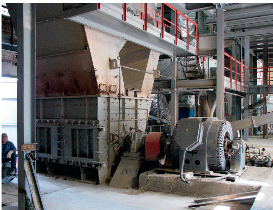
Рис. 1. Тангенциальная молотковая мельница со встроенным лабиринтным сепаратором
