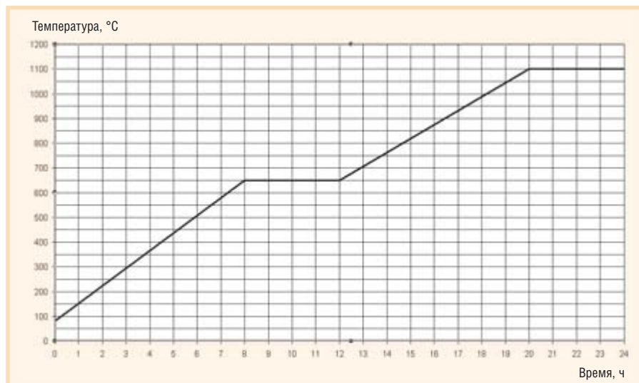
Рис. 8. Скорректированный на основе экспериментальных данных график сушки сталеразливочного ковша, футерованного огнеупорами производства фирмы Mayerton
