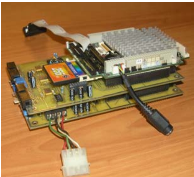
Рис. 3. Платы цифрового блока обработки сигнала для ЛДИС
