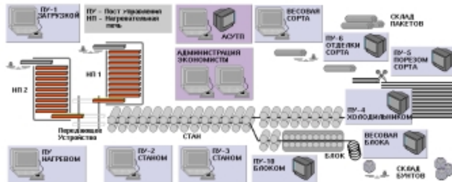
Рис. 1. Схема технологической линии сортопрокатного стана
