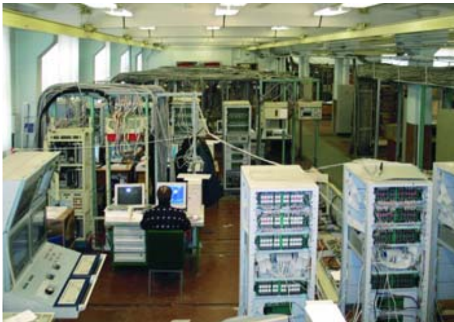
Рис. 2. Испытательный стенд, построенный на контроллерах фирмы Advantech
