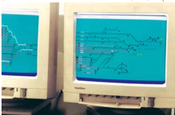
Отображение поездной обстановки на станции
