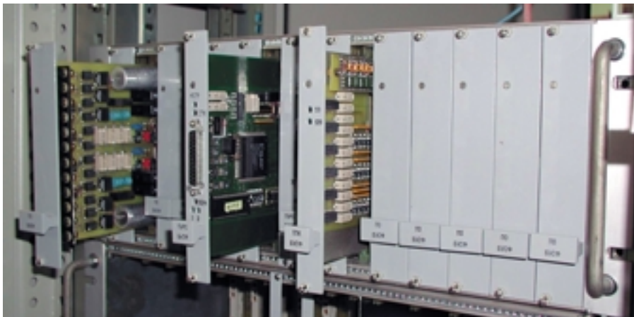
Рис. 6. Блок управления 10 огнями светофоров (БУСОФ)
