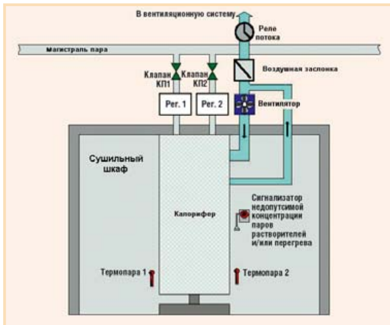
Рис. 1. Технологическая схема шкафа
