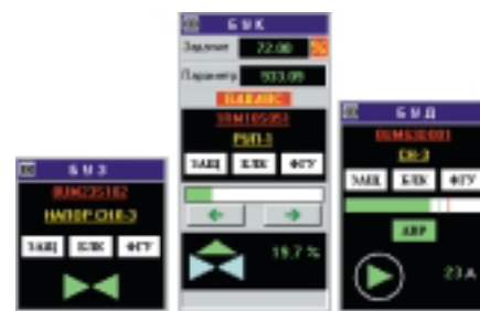
Рис. 18. Блоки управления в подсистеме ДУ
