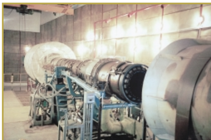
Испытательный бокс с двигателем
