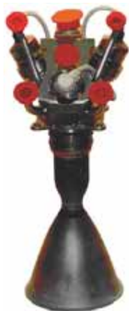
Рис. 1. Внешний вид двухкомпонентного ракетного двигателя малой тяги РДМТ135М
