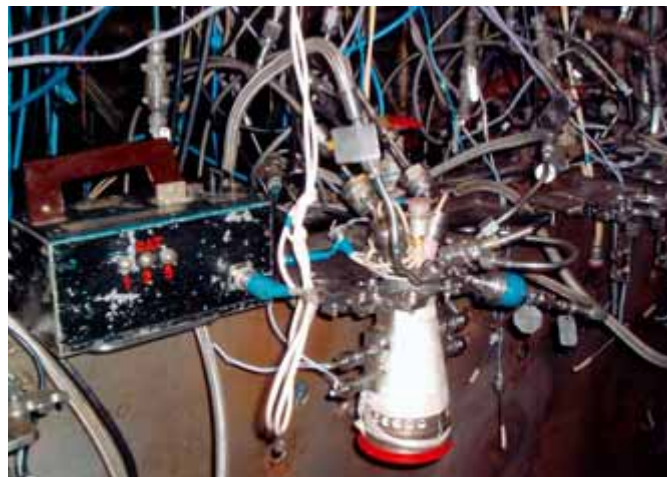
Рис. 6. Двигатель РДМТ135М в теплоизоляционном кожухе, установленный на огневом стенде
