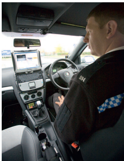
Рис. 1. Ноутбук CF-19 на док-станции в полицейском автомобиле
