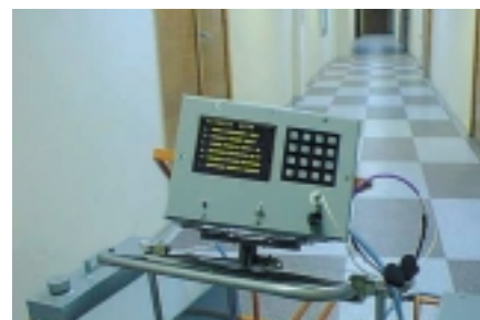
Рис. 5. Дисплей Planar EL640.480.AM8-ET в составе дефектоскопа АДС-02
