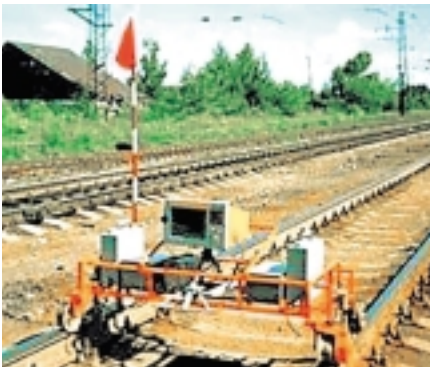
Рис. 2. Ручная дефектоскопическая тележка с АДС-02
