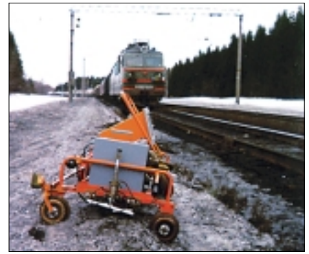
Рис. 3. Эвакуация дефектоскопической тележки при приближении поезда
