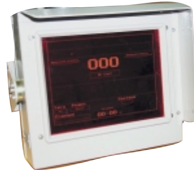
Рис. 8. Установка плоскостанельного дисплея Planar в эргономичном конструктиве
