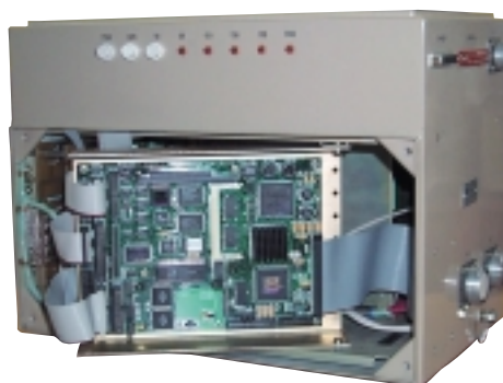
Рис. 7. Одноплатный компьютер PC-510 — основа бортового контроллера
