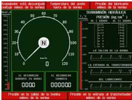
Рис. 8. Рабочий экран АСК-3И (выставлены аварийные сообщения: значения давления равны нулю, температура превышает норму, упало напряжение аккумуляторной батареи)
