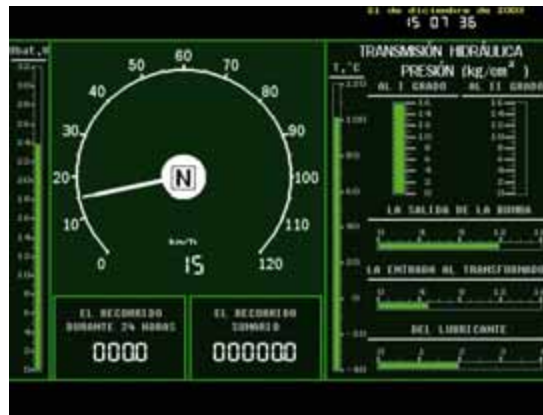
Рис. 8. Рабочий экран АСК-3И (выставлены аварийные сообщения: значения давления равны нулю, температура превышает норму, упало напряжение аккумуляторной батареи)
