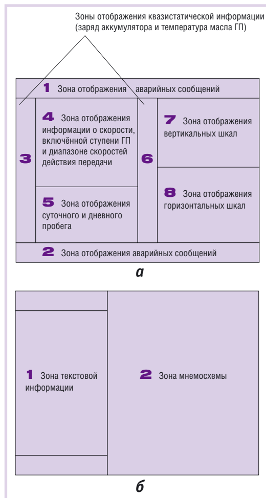
Рис. 7. Распределение областей отображения информации: а — для рабочего экрана, б — для диагностического экрана
