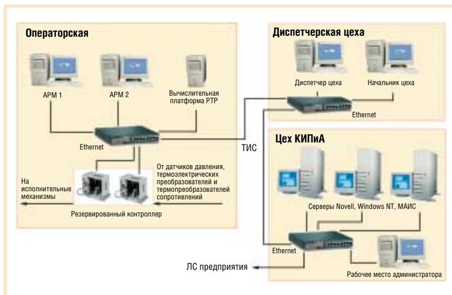
Рис. 4. Структурная схема АСУ ТП комплекса вращающихся печей ЦМП-3
