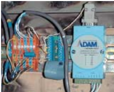
Рис. 6. Коммуникационный модуль ADAM-4521 для дисплея IEE
