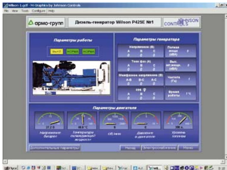
Рис. 6. Копия экрана автономной системы управления бесперебойным энергоснабжением
