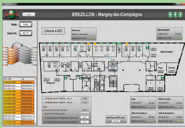
Мониторинг микроклимата и концентрации CO 2
