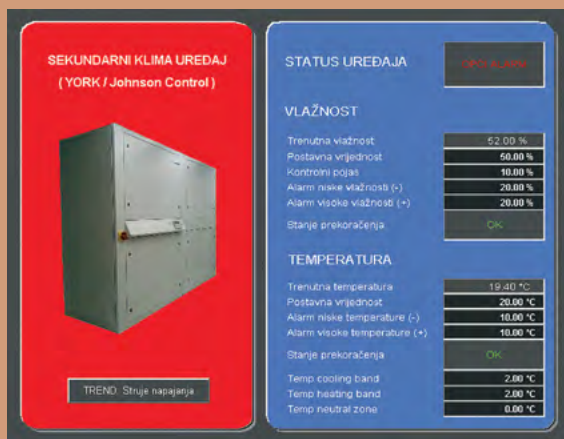
Экран мониторинга кондиционера (пример состояния тревоги)
