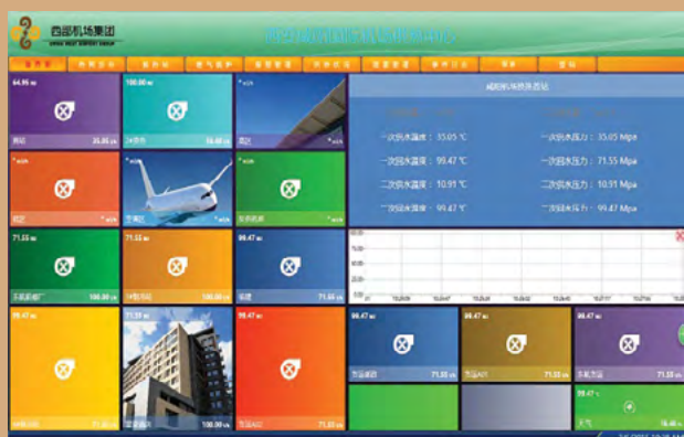
Главная страница экрана управления аэропортом Сиань Сяньян, созданная в ICONICS GENESIS64™
