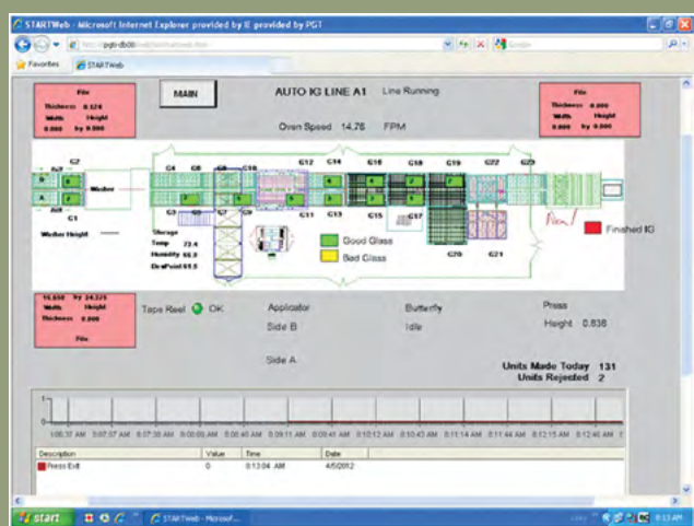
Экран управления процессом сборки изоляционных стекол
