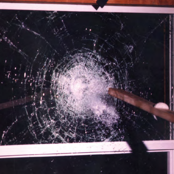
Испытание стекла на ударопрочность на промышленном объекте PGT (Северный Венис)
