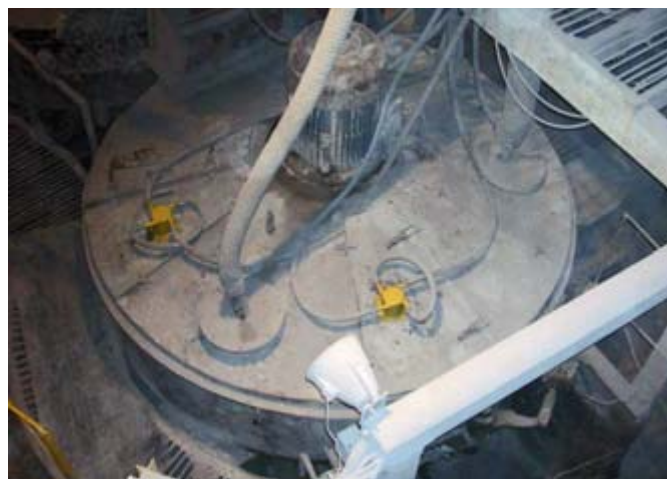
Рис. 7. Бетоносмеситель СБ-138 с центробежными форсунками для распыла воды
