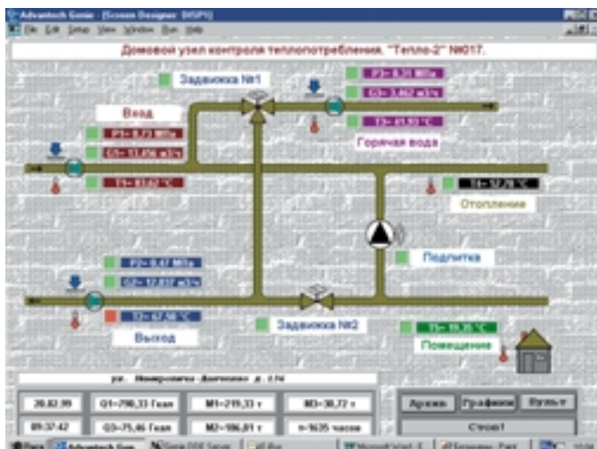
Рис. 6. Мнемосхема системы контроля теплотребления, разработанной в среде Genie в рамках курсового проекта
