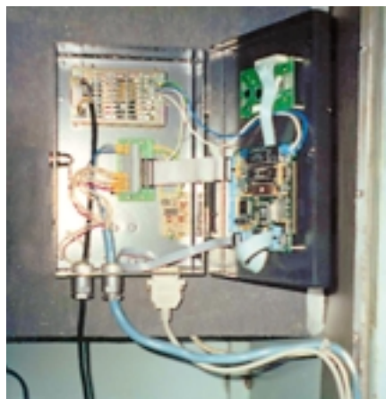
Рис. 2. Внутренняя конструкция вычислителя «ГАММА 055»
