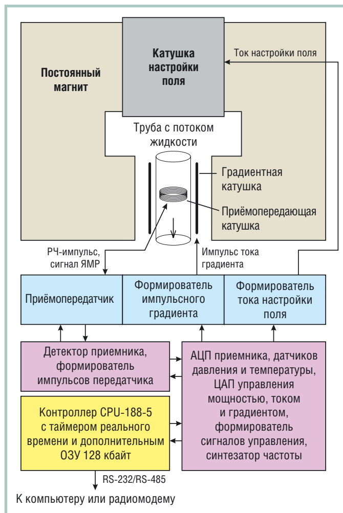
Рис. 2. Блок-схема измерителя расхода и состава скважинной жидкости
