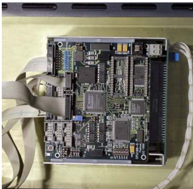
Рис. 5. Каркас 5253 с модулями CPU188-5MX и АО16-V8
