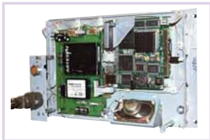
Рис. 10. Блок индикации с жидкокристаллическим дисплеем на базе контроллера CPU686E фирмы Fastwel
