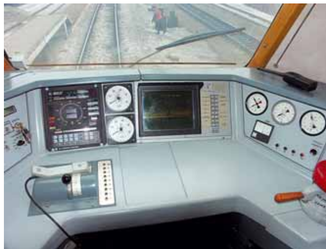
Рис. 11. Электролюминесцентный дисплей в кабине электровоза ВЛ80с
