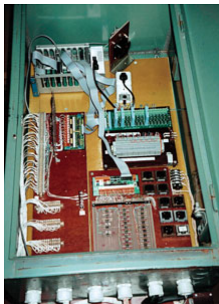
Рис. 1. Шкаф с промышленным контроллером, выполненным на основе процессорной платы Octagon Systems 5025A
