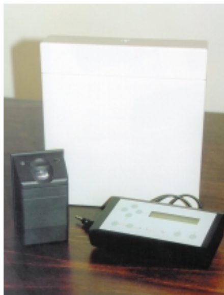
Рис. 3. Комплект оборудования DS100: настенный сканер FS100, контроллер DC100, консоль администратора AC100
