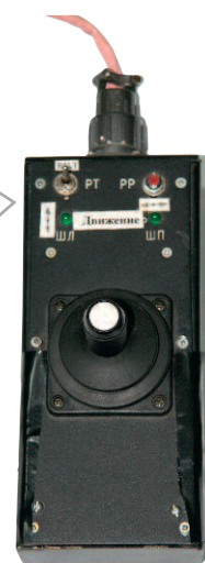
Рис. 4. Джойстик для управления шасси и оружейной турелью МРК-47БТ
