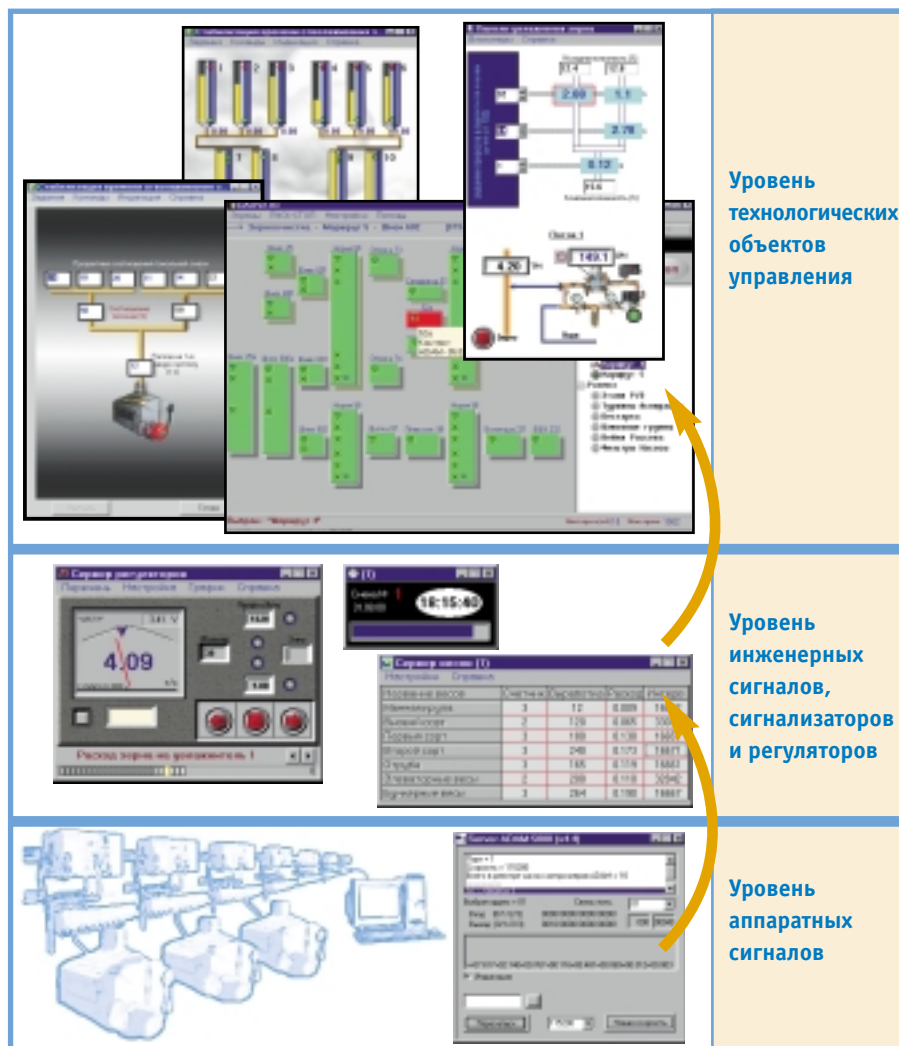
Рис. 2. Структура информационных уровней АСУ ТП мукомольного завода
