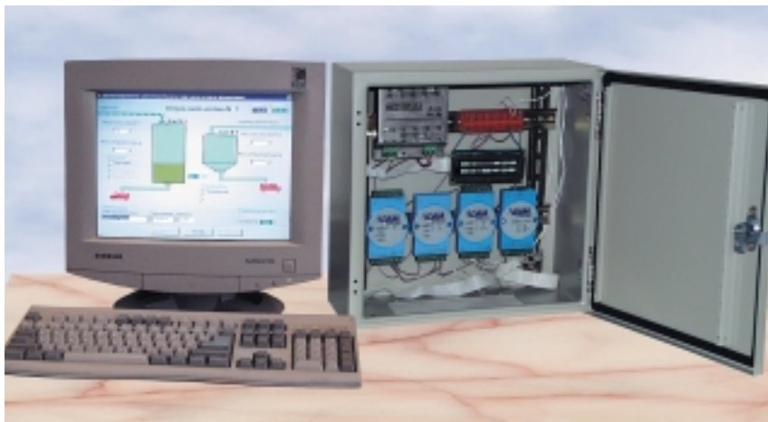
Рис. 3б. Локальная станция и основной пульт управления системой на базе ПЭВМ при отладке в лабораторных условиях
