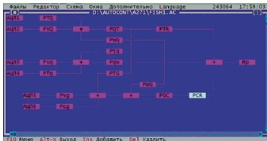
Рис. 3. Внешний вид окна программы с фрагментом модели тестируемого технологического процесса (AutoCont)
