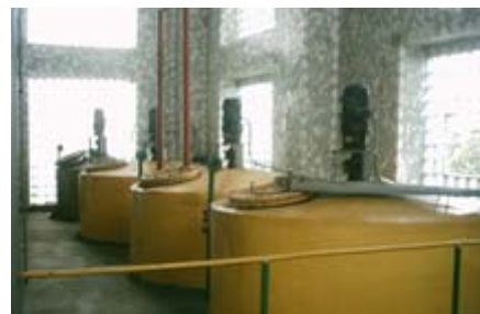
Рис. 2. Технологический участок гидроферментативной обработки крахмала (низкотемпературной варки)
