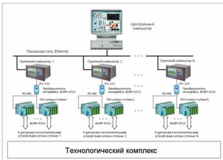
Рис. 7. Структура АСУ ТП многоступенчатого каскада
