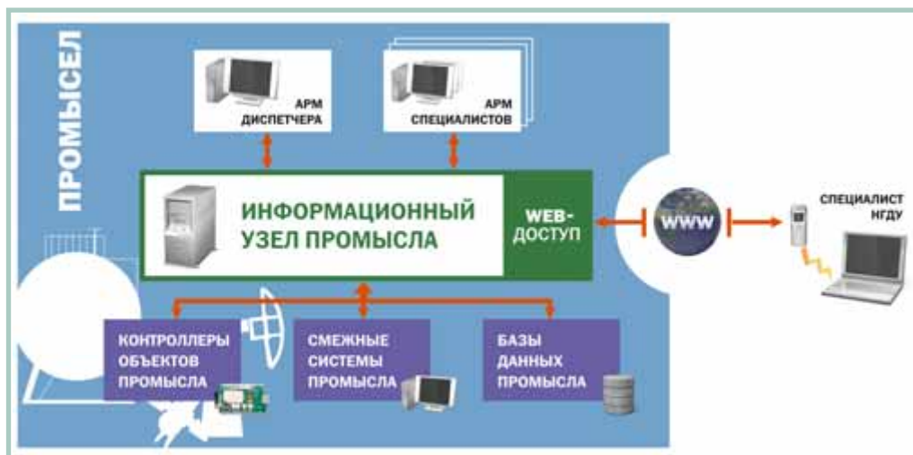
Рис. 2. Схема развёртывания системы «Мега» на промыслах
