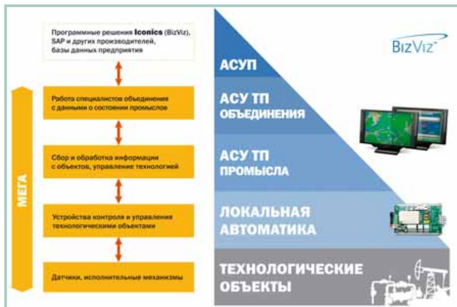
Рис. 1. Место системы «Мега» в структуре системы автоматизации предприятия
