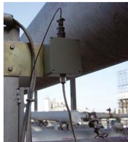
Рис. 5. Канал преобразователя АЭ
