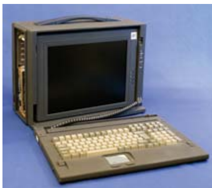
Рис. 7. Компьютер PWS-1409TP фирмы Advantech, используемый в качестве центральной вычислительной станции системы ККМ
