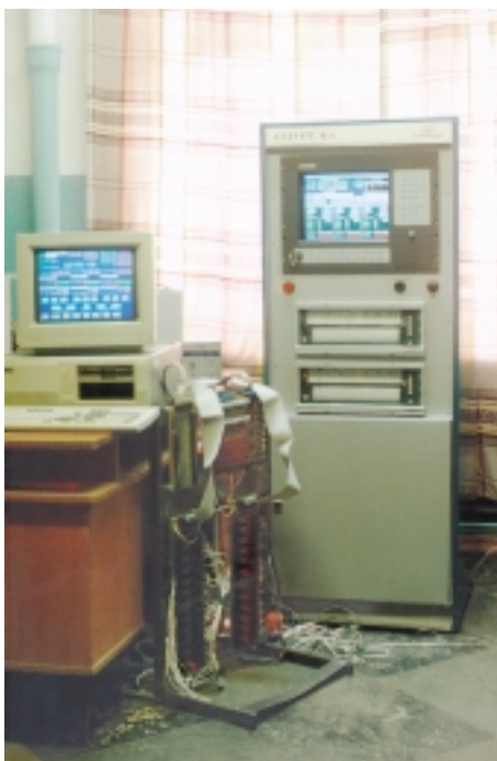
Рис. 2. Внешний вид системы программного управления и регулирования температуры
