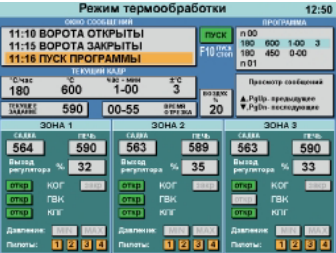
Рис. 4. Вид экрана в режиме термообработки
