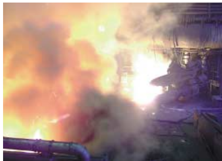
Рис. 5. Выпуск чугуна из доменной печи
