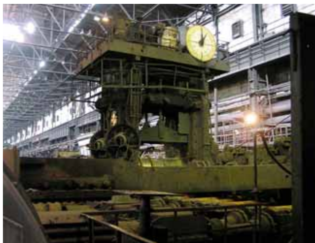
Рис. 1. Внешний вид клетки блюминга
