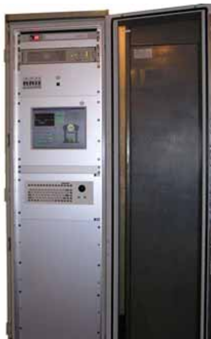
Рис. 4. Внешний вид шкафа САУ блюминга
